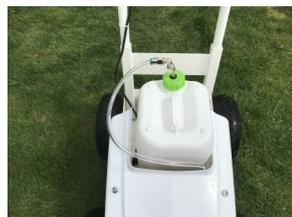
Bidon amovible et étanche servant de réservoir (pas de cuve à nettoyer) , avec canne d'aspiration équipée d'une crépine
