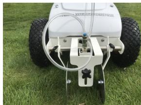
Disques réglables en largeur pour ajuster vos traçages et la buse en hauteur par des vis papillon
