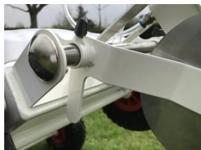
Ergot métallique sur les bras des disques pour une meilleure stabilité lors de la levée de la machine
